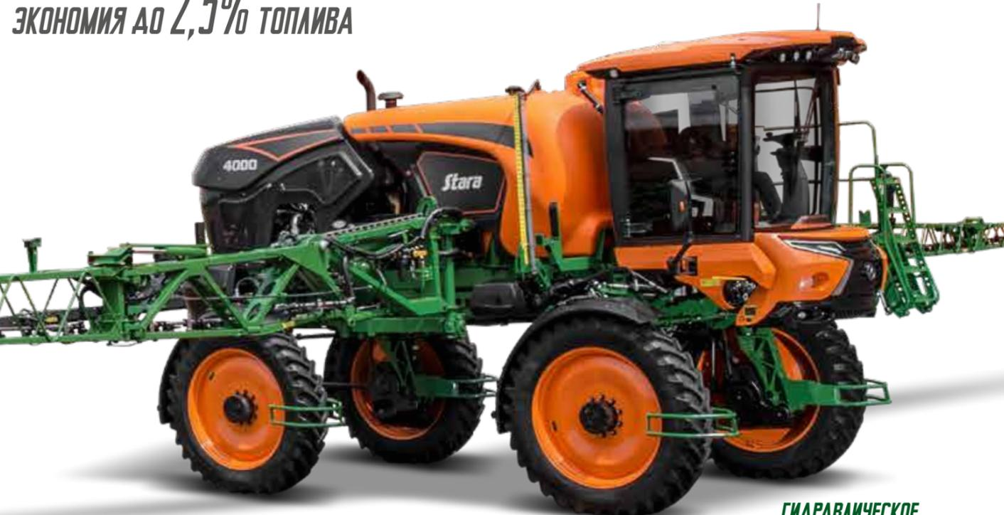
**ГИДРАВЛИЧЕСКОЕ РАЗВИЖЕНИЕ КОЛЕС ОТ 2,90 ДО 3,50 м. В БАЗОВОЙ КОМПЛЕКЦИИ**
